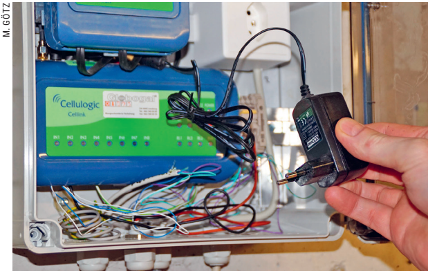
Alarmanlagen zum Handy haben einen Akku eingebaut und müssen regelmässig getestet werden.
