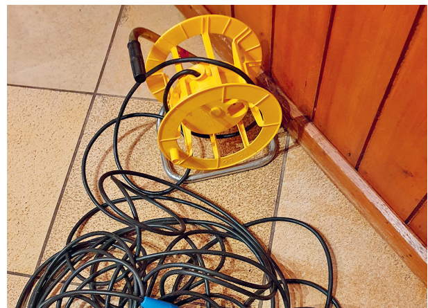
Kabelrollen ganz abwickeln.
