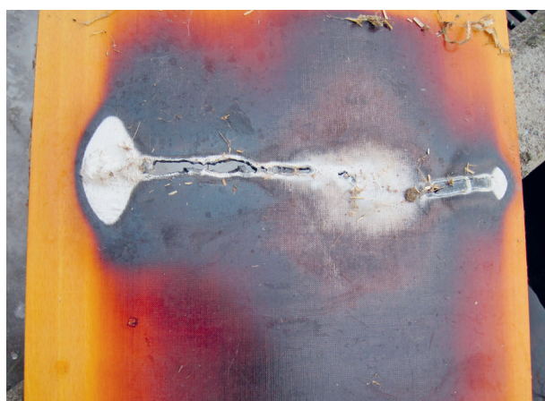
Schwarzverfärbung der Infrarot-Wärmeplatten auf Grund von Alterung und Beschädigung.
