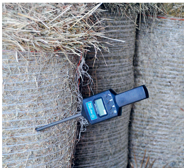
Temperatursonde: Messung der Kerntemperatur.
